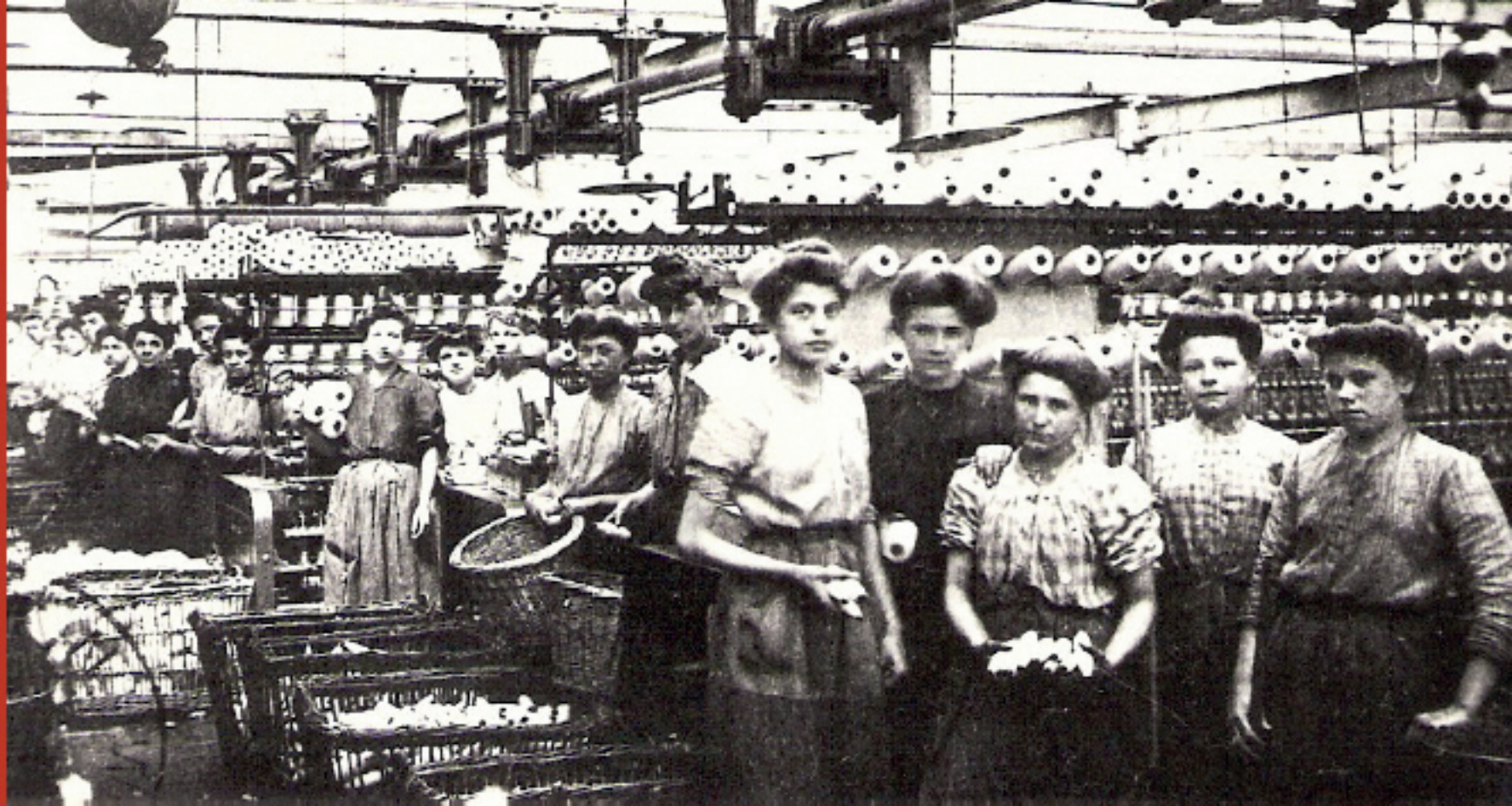
Carte postale vers 1900 : ouvrières de la filature Crépy, aux cheveux attachés pour éviter tout accident ; à droite les machines à étirer et filer le coton.
