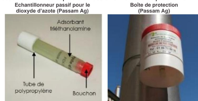
Figure 93 : description du système de prélèvement du NO<sub>2</sub>
